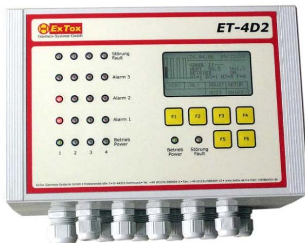
Descripción : Central de detección de gases para detección y medida de gases explosivos y/o tóxicos, al igual que oxígeno. Opcionalmente para detectores de humo. Display gráfico. 3 niveles de alarma por canal. 12 relés de libre configuración.
