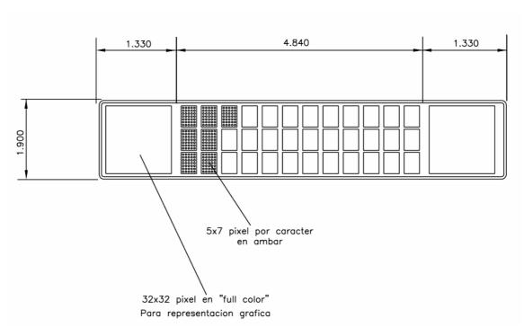
SISTEMA DE CONTROL Y SEÑALIZACIÓN – PANEL PMV 3/12 + GR 32 X 32 FC
